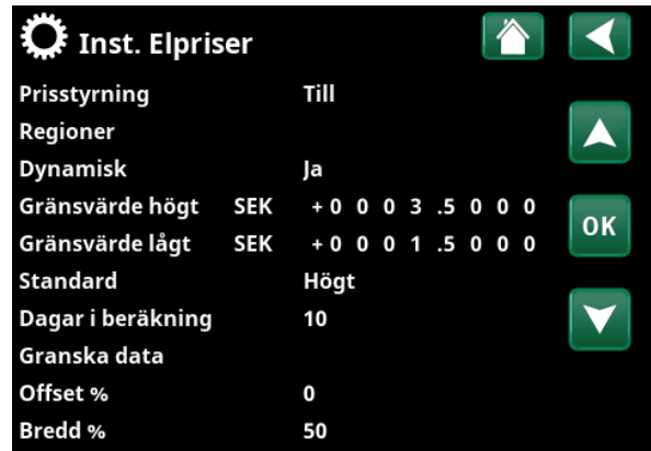
Meny "Avancerat/Inställningar/Kommunikation/Elpriser" vid val "Avancerat/Definiera/Kommunikation/myUplink:Ja".
