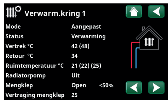
Het menu toont gedetailleerde werkingsdata van de geselecteerde verwarmingskring. Klik op de pijlen of veeg om gedefinieerde verwarmingskringen te tonen.
