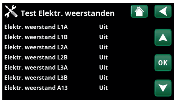
Menu: "Installateur/Service/Functietest/Elektrische weerstand".
