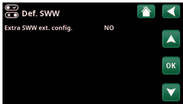
Menu: "Installateur/Definieer/SWW" Op menubalk "Extra SWW" wordt de normale mode voor het externe sturing ("Normaal Open (NO)" of "Normaal Gesloten (NG)") opgegeven.
