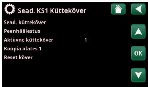
Menüü „Paigaldaja/Seadistus/Küttering/Küttering 1/Kütteköver“.
