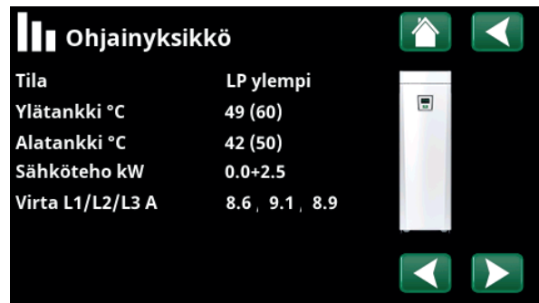
Valikko Käyttötiedot/Ohjainyksikkö. Selaa ohjainyksiköitä ja lämmitysjärjestelmiä napsauttamalla nuolia tai pyyhkäisemällä.
