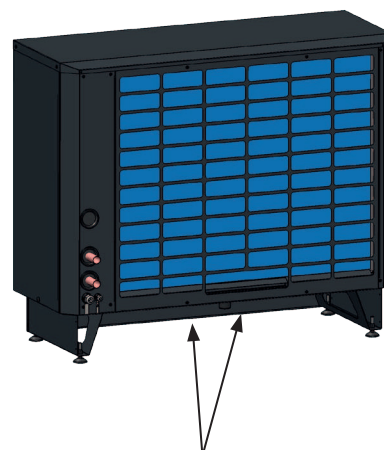
Kondensbakke og kondensvandafløb.
