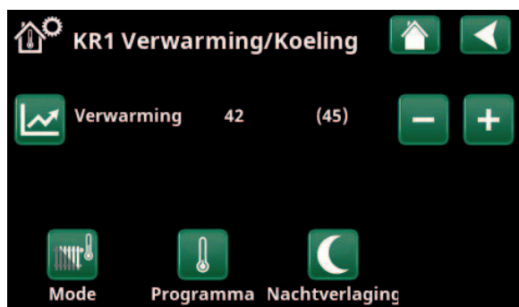
Menu "Installateur/Definieer/Verwarmingskring/Verwarmingskring 1". Het verwarmingskring heeft geen ruimtevoeler. Het setpoint (vertrektemperatuur 45 °C) staat tussen haakjes, de huidige vertrektemperatuur 42 °C staat links van het setpoint.
