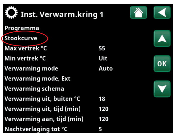
Onderdeel van het menu: "Installateur/Instellingen/Verwarmingskring/Verwarmingskring 1".
