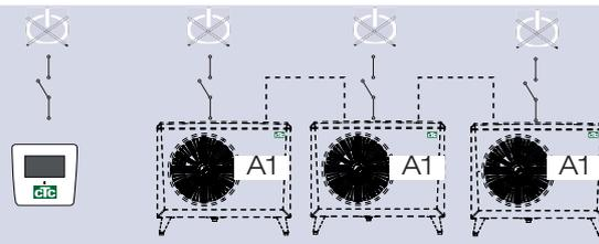
2. Alimentare il controllo (EcoLogic Pro o EcoZenith i550 Pro) e il CTC EcoPart 600M che sarà numerato come pompa di calore 2 (PDC2).
