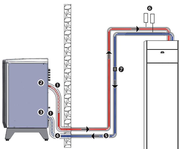
1. Tubo flessibile rinforzato con filo metallico e impermeabile per acqua calda, min. 1" (accessorio del CTC). Lunghezza del tubo flessibile: 1.000 mm dal prodotto.
