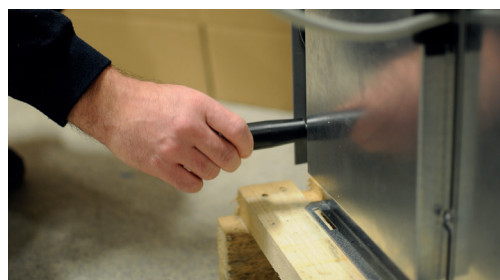
2. Csatlakoztassa a két hordozófogantyút a hűtőmodul aljához.
