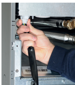
1. Kösse le a hűtőmodul tápkábelét és tömlőit.
