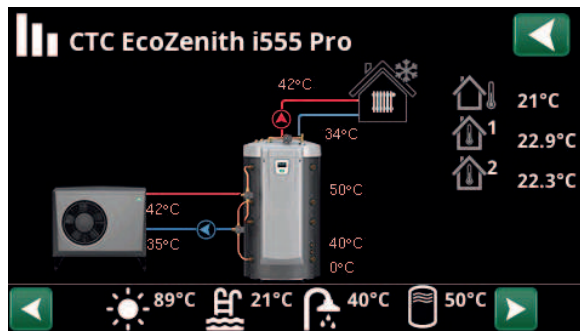
Hovedmenusejde for "Driftinfo" med luft til vand-varmepumpen CTC EcoAir tilsluttet.
