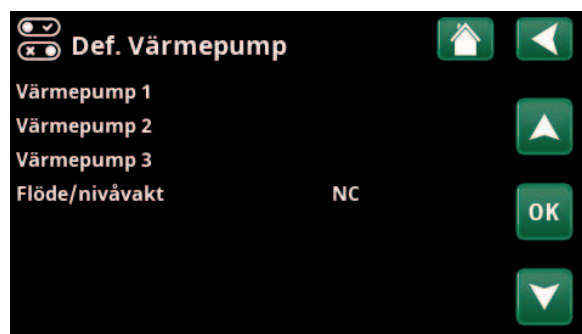
Meny "Avancerat/Definiera/Värmepump". Markera en värmepump och tryck "OK" för att göra inställningar.
