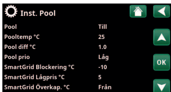
Meny "Avancerat/Inställningar/Pool". Pooltemperaturen höjs med 5 °C när funktionen "SmartGrid Lågpris" aktiveras.
