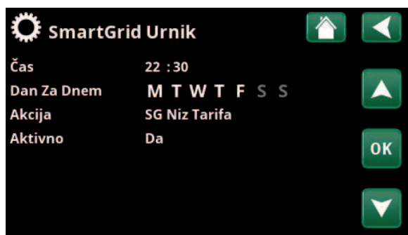
Funkcija SmartGrid »SG Nizka Tarifa« je predvidena med tednom od 22:30 do 06:00. V meni vstopite tako, da v meniju »Instalater/ Nastavitve« izberete parameter »SmartGrid Urnik«.
