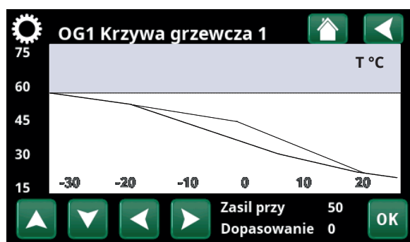
Menü „Instalator\Ustawienia\Obieg grzewczy\Obieg grzewczy 1/ Krzywa grzewcza”.
